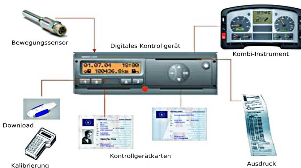
Abbildung 2.1: Komponenten des digitalen Tachographen
